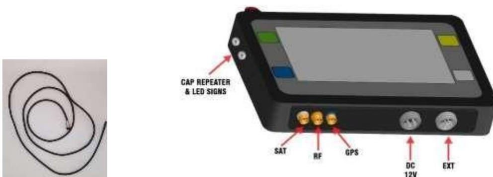
**Antenas:** la antena del GPS (ver Fig. 1) y la antena satelital (ver Fig. 2) deben estar colocadas OBLIGATORIAMENTE en el techo del vehículo (ver Fig. 4), prestando atención que no haya ningún objeto encima de ellas, sobre todo, objetos metálicos. Las mismas tienen base imantada y una cinta bi faz para su sujeción al techo por lo que no es necesario la sujeción con precintos o cinta pata o plomo, ya que estas últimas, interfieren con la señal.
