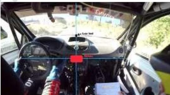
**Soporte:** (ver Fig. 6) El soporte debe estar debidamente sujetado y en la posición que se indica (ver Fig. 7), *habrá una tolerancia de (+ -) 15 centímetros en su ubicación.* NO se permiten precintos para sujetar el soporte ya que el movimiento del auto hace que el mismo se afloje. El mismo tiene aletas plegables por troquelado, las cuales deben ajustarse para que el Sirius calce firmemente dentro. **NO ESTA PERMITIDO ELIMINAR NINGUNA DE LAS ALETAS.**
